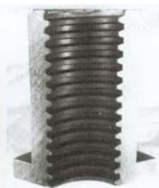
moglice bevonat, anya, acélból, trapéz-menettel készbevonat utánmunkálás, nélkül
