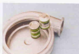
Lunckerok kijavítása szivattyúházban
